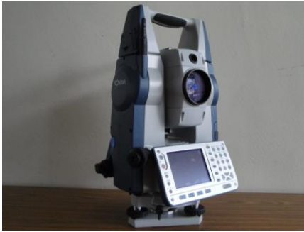
トータルステーション (角度・距離測定機器)
